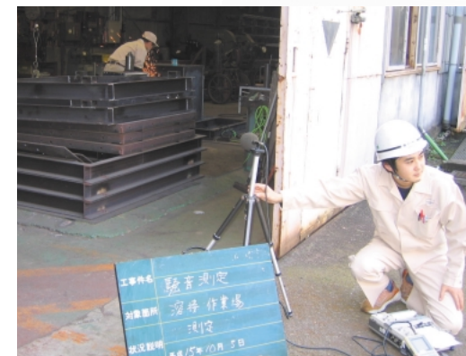
騒音の発生源とその周囲に与える影響を数値化することにより騒音防止の適切な措置のご提案も行っています。
